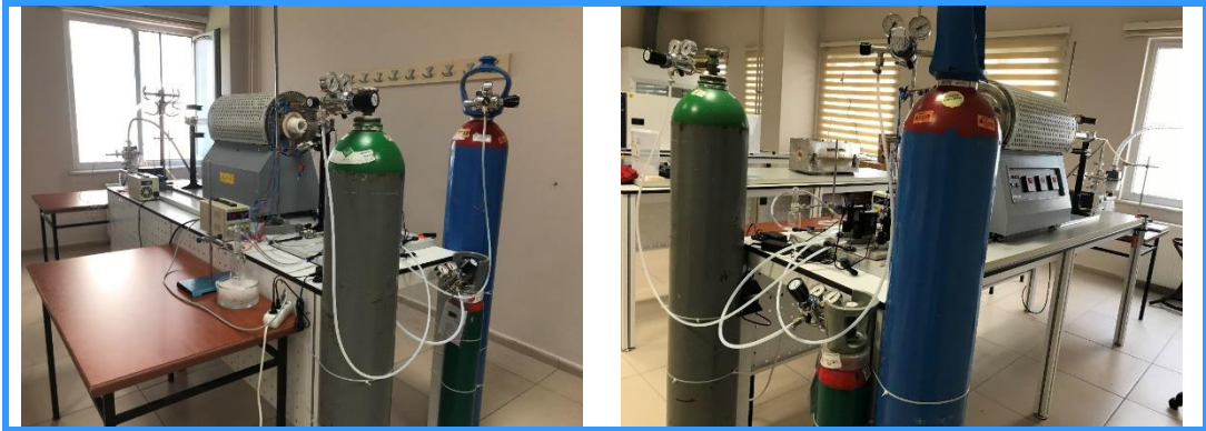
Şekil 4.2. Deneyleri gerçekleştirdiğimiz kimyasal buhar biriktirme (CVD) sistemi.
